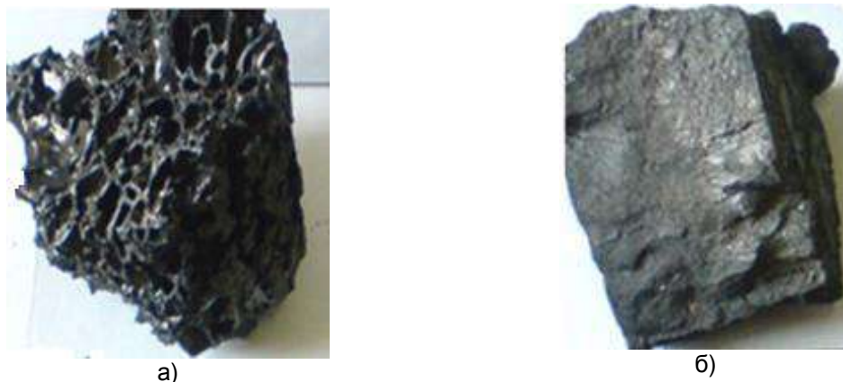
Рисунок 2 – Внешний вид коксовых матриц, полученных при различных режимах карбонизации: а – традиционная технологии при атмосферном давлении; б – изостатическая технология
