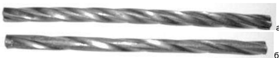
Рисунок 3 – Арматурный профиль (а – пятизаходный; б – трехзаходный)
