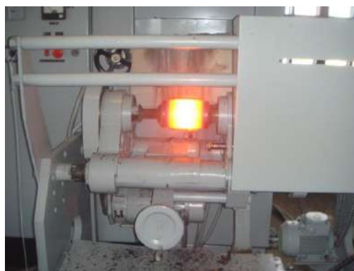
Рисунок 1 – Процесс нанесения покрытий методом центробежной индукционной наплавки
