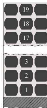
Рисунок 2 – Модель укладки частиц в обмазке
