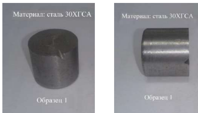
Рисунок 4 – Внешний вид образцов из стали 30ХГСА после годовой выдержки на воздухе, при T=23-25 С
