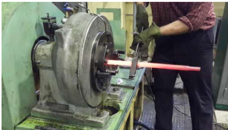
Рисунок 2 – Ковка прутка никелида титана диаметром 18 мм на РКМ1
