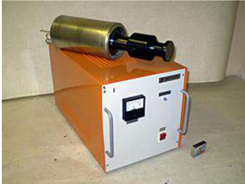
Рисунок 1 – Внешний вид ультразвукового диспергатора УЗД1-2,0/22 мощностью 2 кВт
