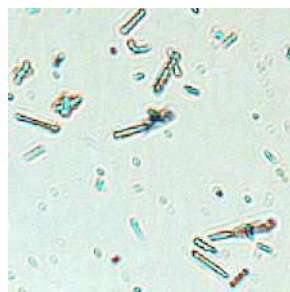
Рисунок 5 – Микрофотографии фуллеритов C60(OH)42, исходная чистота C60=95%, 50x50 мкм, светлое поле (а,б); 25x25 мкм, скрещенные николи (в)
