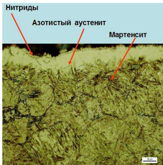
Рисунок 2 – Микроструктура поверхности катания банджа, плазменно-упрочненного после эксплуатации
