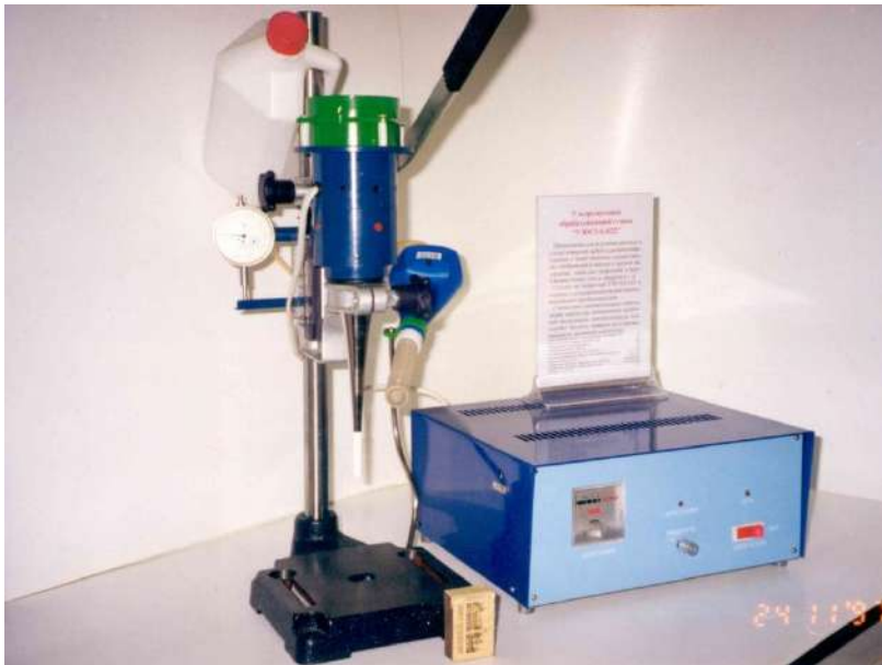
Рисунок 1 – Внешний вид ультразвукового станка типа УЗОС2-0,1/22
