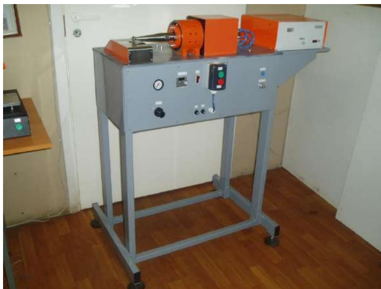
Рисунок 3 – Внешний вид шовной ультразвуковой сварочной машины типа МШУ1-0,1/22
