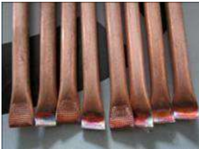
Рисунок 1 – Образцы медных трубок, герметично заваренных ультразвуковой сваркой
